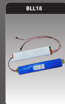
HT3W Loại đèn: LED 3W Điện áp: 220V/50Hz Chế độ nạp: tự động Pin: Ni-cd Thời gian nạp: 20-24 giờ Thời gian thấp sáng: >4 giờ Lắp âm
