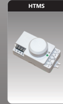
HTMS Công suất: <0.9W Kích thước LxWxH (mm): 91x42x41 Điện áp: 220V/50Hz Công suất tải: Max 1200W Tầm cảm biến: 1-8m Thời gian trễ: 8s - 12 phút
