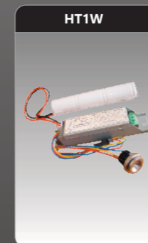
HT1W Loại đèn: LED 1W Điện áp: 220V/50Hz Chế độ nạp: tự động Pin: Ni-cd Thời gian nạp: 20-24 giờ Thời gian thấp sáng: >4 giờ Lắp âm
